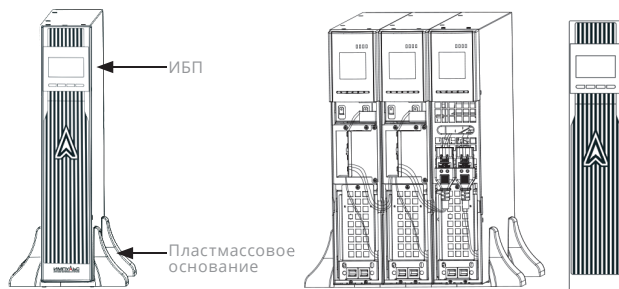
Рисунок 13. Изменение положения ЖК-дисплея при вертикальной установке ИБП
